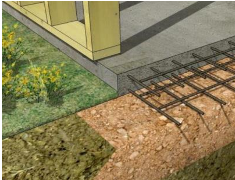
Figura 3: Radier Fonte: Edifique (2013).
