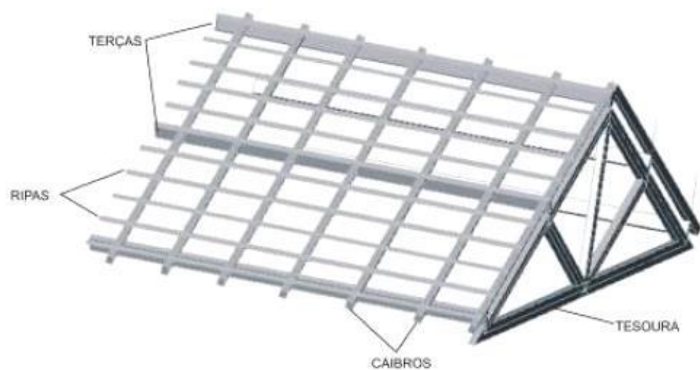
Figura 6: Estrutura Da Cobertura Fonte: Meirelles e Pala (2010).
